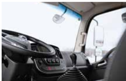
ТОНКИЕ СТОЙКИ ЛОБОВОГО СТЕКЛА И БОЛЬШИЕ НАРУЖНЫЕ ЗЕРКАЛА С ОБОГРЕВОМ
