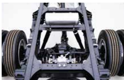
СТАЛЬНАЯ РАМА С С-ОБРАЗНЫМ ПРОФИЛЕМ
