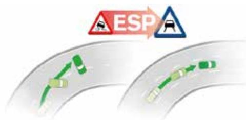
**! Система динамической стабилизации на автомобилях SDAC J6/J7.5 работает в комбинации с барабанными тормозами.**
