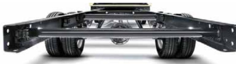
C-образная рама шасси обеспечивает высокую прочность конструкции и, благодаря плоской поверхности, облегчает работы, связанные с установкой надстроек.
